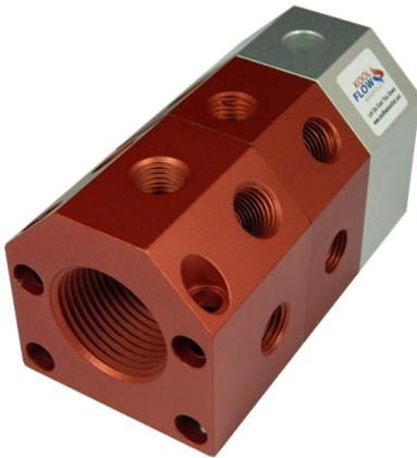
El diseño modular del Manifold Kool Flow™ permite hacer cambios en cualquier comento de acuerdo a sus necesidades. La Serie FB2 tiene un agujero de entrada de 1" con opción de agujero de salida de 1/4" o 3/8". El conjunto "Individual" elimina la necesidad de un costoso conector final, permitiendo el montaje de manifolds fríos y calientes en diferentes ubicaciones.
