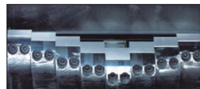
Diseño de cuchilla escalonada hecha de acero endurecido D2
