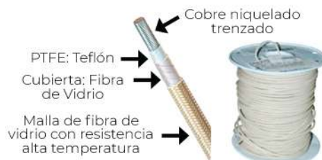
Cable para Resistencias de Alta temperatura
