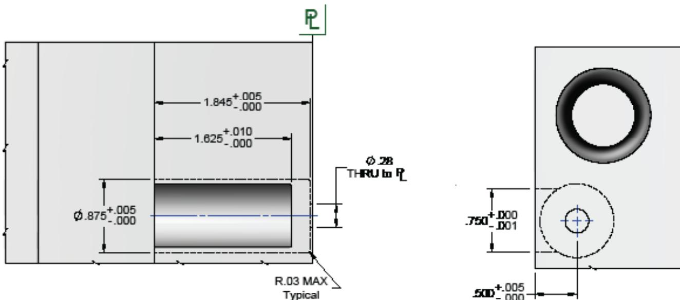
**Material:** Cubierta de nylon con fibra de vidrio
