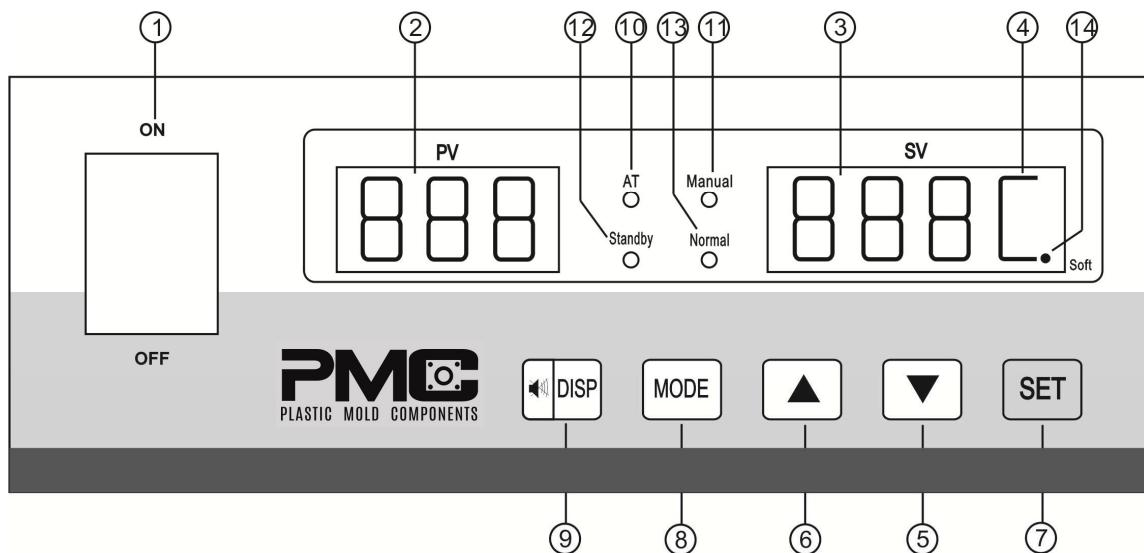
① **Interruptor de encendido:** Encender o apagar
