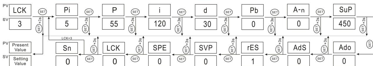
1) Pi: valor de filtración. Usado para reducir el influjo de interferencia.
