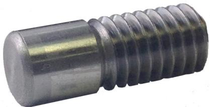
El Accesorio de Perno Posicionador Con Rosca contiene 3/8-16 roscados externos en una punta y un dowel de .3750" de diámetro en la otra punta. Puede instalarse en un agujero 3-8/16 al extremo de un pilar de soporte para permitir una instalación tipo dowel.
