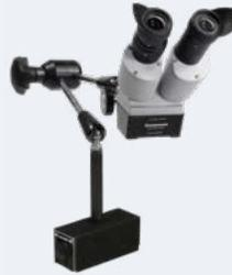
El alcance 10X viene con protección ocular con obturador interno, base magnética y LED iluminación.
